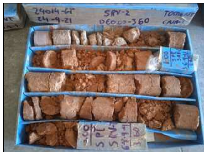
Fotografía 2.- Sondeo 2, caja de 0.00 a 3.60 m
